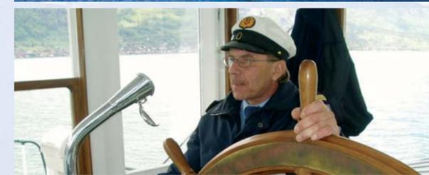
ausgerüstet, doch auch historische Elemente blieben erhalten: So gibt der Kapitän vom Steuerhaus aus seine Kommandos über ein Sprachrohr nach unten in den Maschinenraum, der Maschinist bestätigt das Kommando. Der Antrieb der Dampfschiffe kann übrigens nur vom Maschinenraum aus geregelt werden. Der Kapitän beziehungsweise der Steuermann bedient das Ruder und hat nur »verbale Zugriff« auf Geschwindigkeit und Vor- oder Rückwärtsfahrt seines Schiffes.
