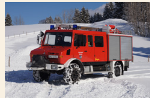
Das LF 8 der FF Oberstaufen. Basisfahrzeug ist ein Unimog 1300 L, der Aufbau stammt von Ziegler. Das Fahrzeug ist auch für Wasserförderung über lange Strecken ausgerüstet.
