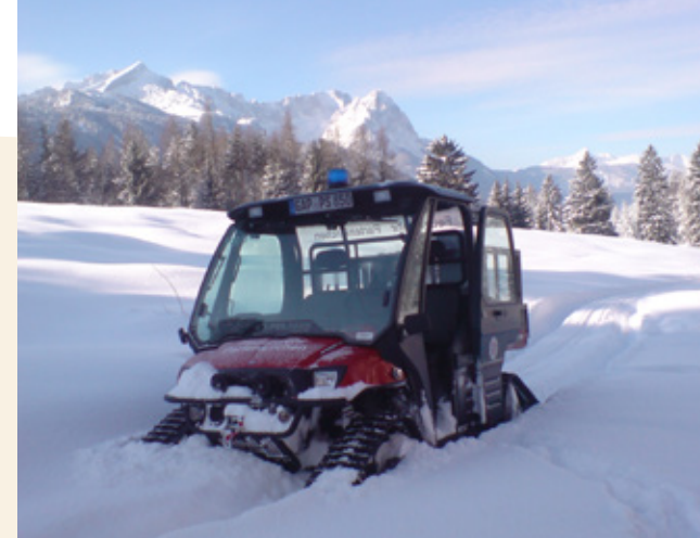
Interessantes Fahrzeug der FF Partenkirchen auch für Touren im Schnee, freilich mit nur minimaler Zuladung. Das Fahrzeug Polaris Freedom-Ranger 4x4 700 ist im Sommer auf Rädern unterwegs, im Winter auf Raupenketten.
